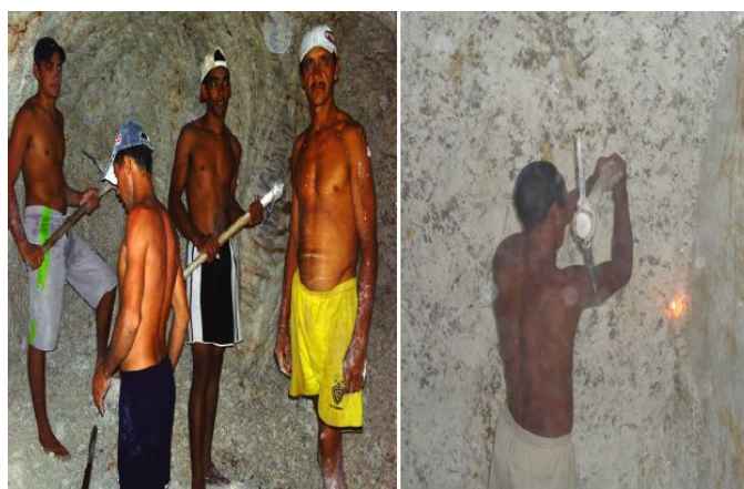
Figura 03 - Processo de Extração de Caulim em Escavações Subterrâneas.
